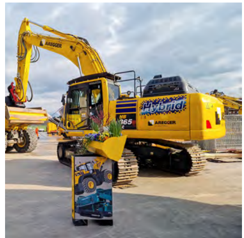
Mit dem Hybridbagger HB 365 (hier bei der Einweihung im Frühling 2025) lässt sich der Kraftstoffverbrauch um einen Drittel verringern.
